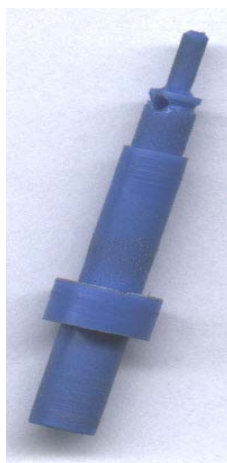
Slika 2: «Samsung test ključ» za namještanje umjernog «kalibracijskog koda»
